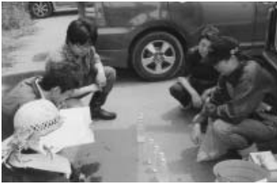
3カ月に一度、松川浦に流れ込む宇多川と小泉川の6ポイントで水質調査を行う。pH、温度、電気伝導率、チッソ・リン・CODパックテストなどを記録する。
